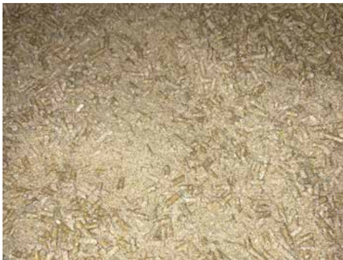
Rotura de pélets por mal mantenimiento de los sinfines
