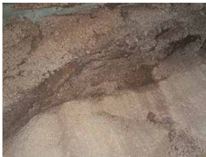
Costra adherida a comedero-tolva por falta de limpieza de paredes
